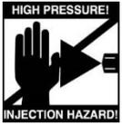
**Warnung VERLETZUNGSGEFAHR! Nie ohne Düse spritzen! Spritzpistole sichern! Spritzpistole bei Montage und Demontage der Düse und Arbeitsunterbrechungen immer sichern, so dass keine unbeabsichtigte Betätigung erfolgen kann. Versuchen Sie niemals, die Düse mit den Fingern zu säubern. Nicht in den Spritzstrahl greifen!**
