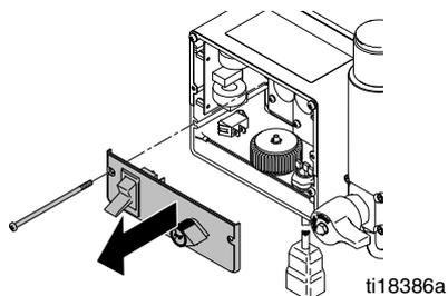
4. Den Schnellspül-Schalter an der Steuerungskonsole ausstecken.
