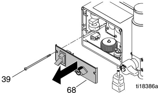
5. Die Netzkabelstecker und Filterplattenstecker vom ON/OFF-Schalter abziehen und die Steuerungskonsole abnehmen.
