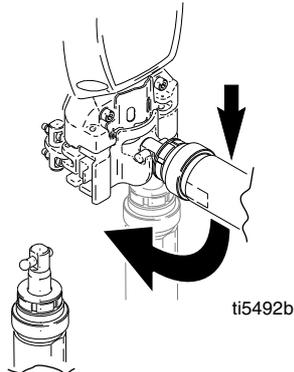
2. Pumpe in die Verbindungsstange schieben. Pumpenstift bis zum Anschlag hineindrücken. **ANMERKUNG:** Der Stift muss einrasten.
