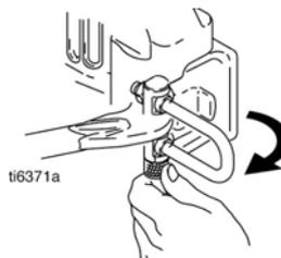
9. U-Bolzen auf den Vorsprung der Pumpentür setzen.
