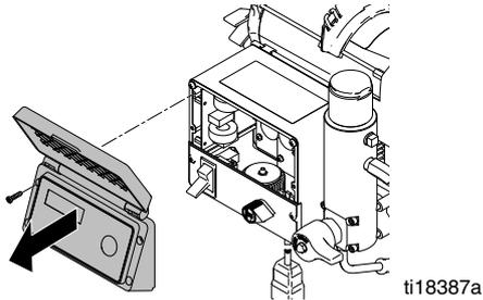
3. Den Display-Stecker von der Motorsteuerkarte lösen.
