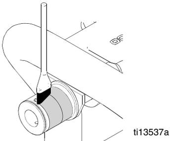
2. Darauf achten, dass sich zwei Unterlegscheiben und eine Wellenfeder auf der Nabe befinden, bevor der Schlauchaufroller wieder installiert wird.
