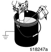
5. Das Ablassrohr in einen Eimer stecken. Entlüftungsventil nach unten in die DRAIN-Position drehen.
