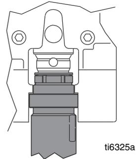
4. Pumpentür schließen und Federgriff in Position drehen. Nicht festziehen.
