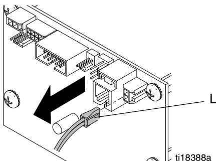
7. Die Netzstecker der Motorsteuerkarte (K) von der Filterplatte (146) lösen.
