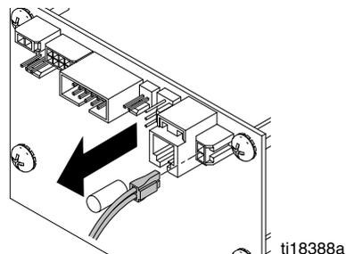
5. Den Schnellspül-Schalter aus der Steuerungskonsole herausdrehen.
