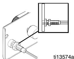
2. Gewindedichtmittel auftragen und Kontermutter auf der Gewindeleiste festziehen.
