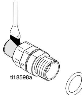
8. Mit einem 1,5-Zoll-Schlüssel das Rückschlagventil sicher an der Pumpe festziehen.
