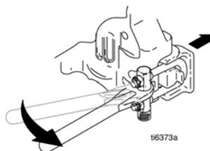
8. U-Bolzen der Verriegelung aus der Aussparung in der Pumpentür drehen.
