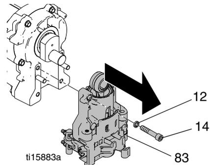
6. Schrauben (6) entfernen und das Getriebegehäuse (90) vom Motor abziehen.
