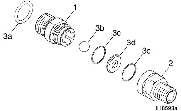
7. Rohrdichtmittel auf das Gewinde am Einlass des Rückschlagventils auftragen.
