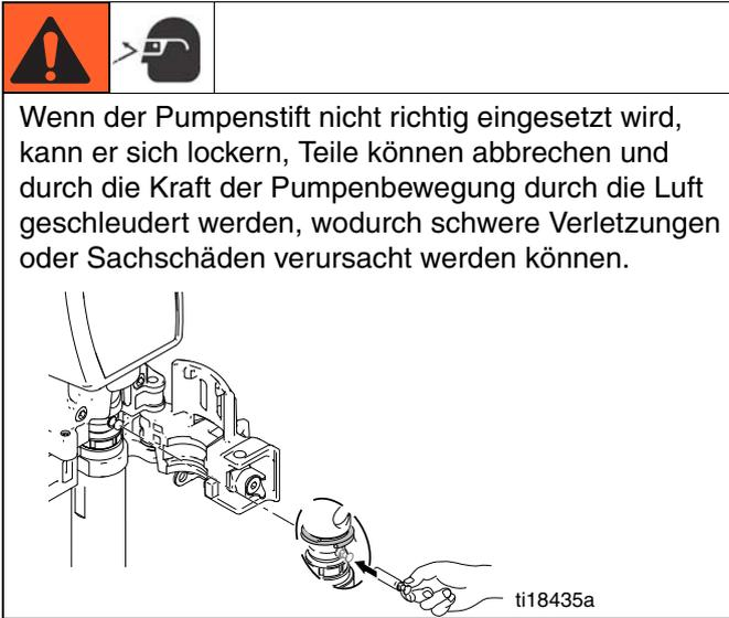
1. Kolbenstange mit der Stifthalterung einstellen, um die Kolbenstange herauszuziehen. Kolbenstange auf eine harte Oberfläche klopfen, um die Kolbenstange hinein zu schieben.
