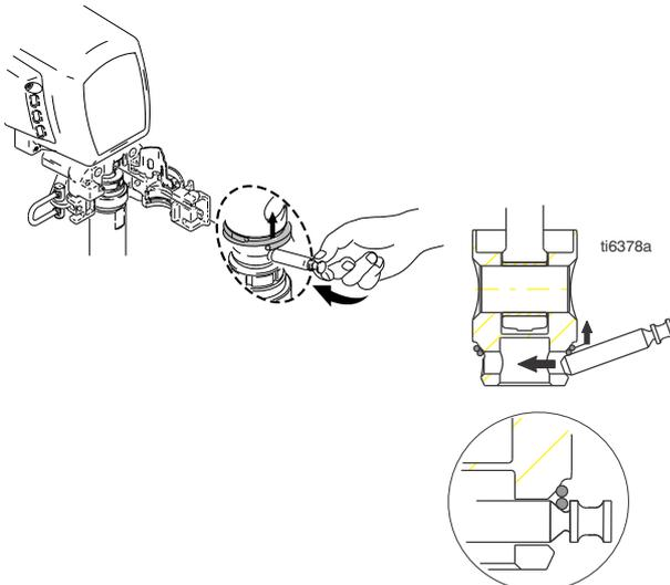
3. Pumpenkragen mit der Nasenleiste des Lagergehäuses bündig machen, damit die Pumpentür geschlossen werden kann.
