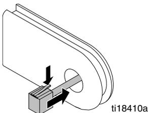
7. Die Sensorleitung durch einen 3/4-Zoll-Ringschlüssel stecken und Sensor und O-Ring vom Ventilblock entfernen.
