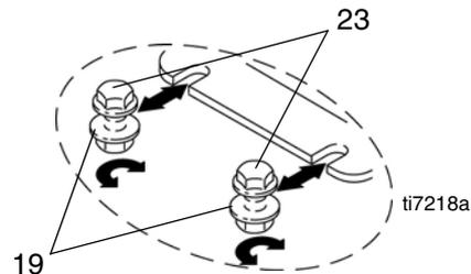
7. Die zwei Schrauben und Muttern an der Seite gegenüber der Steuerkarte entfernen und den Motor aus dem Fahrgestellrahmen nehmen.
