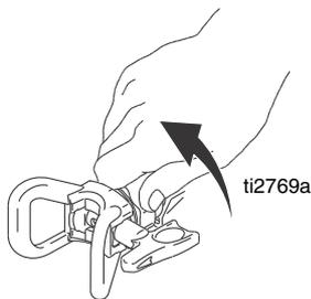
4. Druck auf den niedrigsten Wert einstellen. Achten Sie darauf, dass Sie sich nicht im **Modus "E-Control"** befinden (siehe Bedienungsanleitung). Die Pistole abziehen, um den Druck zu entlasten.
