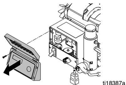
3. Die zwei Schrauben herausdrehen und dann die Steuerungskonsole entfernen.
