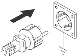
Stecker nicht verändern! Eine Manipulation des Steckers führt zum Erlöschen der Garantie. Spritzgerät nicht in Betrieb nehmen, wenn der Erdungsstift des Netzkabels beschädigt ist.
