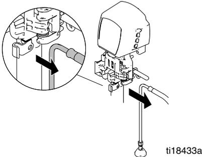
3. Ziehen Sie den Materialschlauch vom Rückschlagventil ab.
