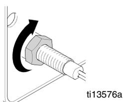
3. Den Schnellspül-Schalter an der Steuerungskonsole einstecken.
