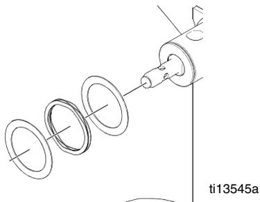
3. Schlauchaufroller am Rahmen installieren. C-Klemme an Rolle und Rahmen befestigen, so dass der Sprengring in seine Position gelangen kann. Sprengring installieren.
