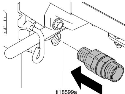
9. Materialschlauch anschließen und mit der Hand mit 70 in-lb (8 N•m) festziehen.
