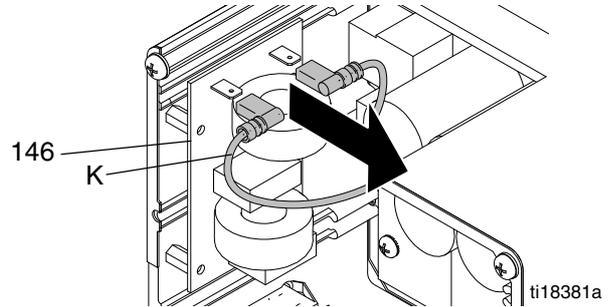
8. Vier Schrauben (163) von der Filterplatte (146) entfernen.
